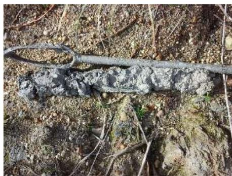
Sondage S1 montrant un horizon homogène de marne grise engorgée sans traits rédoxiques visibles
